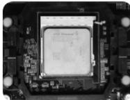
**Nota:** Para instalar la CPU no hagas fuerza excesiva. Si no calza en el socket con facilidad, verifica la orientación de la CPU y vuelve a alinearla hasta que calce sencillamente. La aplicación de una fuerza excesiva puede dañar los pines de la tarjeta madre o de la CPU e invalidar las garantías.
