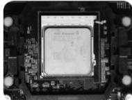
**Opomba:** Pri namestitvi procesorja ne uporabljajte prekomerne sile. Če se procesor ne prilega enostavno v vodilo, preverite njegovo usmeritev in ga poravnajte tako, da se enostavno prilega v vodilo. Uporaba prevelike sile lahko povzroči poškodbo nožic oz. kontaktov na osnovni plošči ali na procesorju, kar ima za posledico izgubo garancije.
