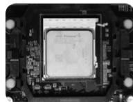
**주의 사항 :** CPU 설치 시 과도한 힘을 가하지 마세요. CPU가 소켓에 잘 들어가지 않는다면, 부드럽게 들어갈 때까지 CPU의 위치를 다시금 확인해 주세요. 과도한 힘을 가할 시 메인보드와 핀 등이 파손 될 수 있습니다.
