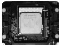
注：CPU の取り付けでは余分な力を加えないでください。CPU がソケットに簡単にはフィットしない場合は、CPU の向きを確認し、簡単にフィットするようになるまで CPU の位置を調整してください。余分な力をかけた場合、マザーボードや CPU のピンが破損し、保証が無効になる恐れがあります。
