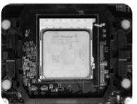
توجه: برای نصب پردازنده از نیروی بیش از حد استفاده نکنید. اگر پردازنده به راحتی درون سوکت
