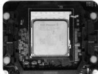
**Observação:** Não faça força em excesso para instalar a CPU. Se a CPU não se ligar no socket com facilidade, verifique a orientação da CPU e alinhe-os novamente até que eles se unam de forma simples. A aplicação de força em excesso pode danificar os pins da placa-mãe ou da CPU e invalidar as garantias.
