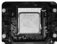
**Catatan:** Jangan menggunakan kekerasan yang berlebihan untuk menginstal CPU. Jika CPU tidak mudah masuk ke dalam soket, periksa orientasi CPU dan menyetel kembali sampai sesuai dengan mudah. Menggunakan kekerasan yang berlebihan dapat mengakibatkan kerusakan pada pin pada motherboard atau CPU dan void garansi.
