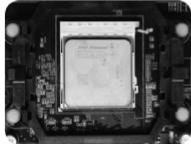
**Note:** N'exercez aucune force excessive pour installer le processeur. Si celui-ci montre une résistance, vérifier l'orientation du processeur et réaligner jusqu'à ce qu'il s'intègre parfaitement. Exercer une trop forte pression sur le matériel peut endommager les pins du socket de la carte mère ou du processeur et annule la garantie.
