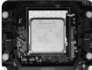
**Nota:** non impiegate una forza eccessiva nell' installare la CPU. Se la CPU non si adatta con facilità al socket controllate che sia allineata nel senso corretto fino a quando non entra perfettamente e senza sforzi. L'impiego di una forza eccessiva può causare danni ai pin della scheda madre o della CPU invalidandone la garanzia.
