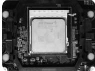
**Примечание:** Не прикладывайте чрезмерных физических усилий, чтобы установить процессор. Если он не входит в сокет легко, проверьте расположение процессора и попытайтесь правильно его расположить до тех пор, пока он с легкостью не будет входить в сокет. Использование чрезмерных усилий может повредить штекеры на материнской плате или процессоре, что влечет за собой потерю гарантии.
