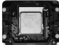
**Uwaga:** nie używaj nadmiernej siły do montażu procesora. Jeżeli występują problemy z instalacją procesora w gnieździe, sprawdź jego orientację. Używanie nadmiernej siły może spowodować uszkodzenie gniazda płyty głównej lub nóżek procesora oraz utratę gwarancji.
