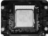
**Nota:** No use demasiada fuerza al instalar la CPU. Si la CPU no fuera fácilmente ajustada en el socket, revise la orientación de la CPU y vuelva a alinear la CPU hasta que se fije con facilidad. Usar mucha fuerza puede dañar los pinos de la placa base.
