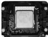
**Anmerkung:** Wenden Sie keine übermäßige Kraft auf, um eine CPU in den Sockel einzubauen. Wenn die CPU nicht leicht in den entsprechenden Sockel passt, überprüfen Sie die korrekte Position der CPU und richten Sie die CPU gegebenenfalls neu aus. Bei übermäßiger Kraftanwendung können die Pins auf der CPU bzw. am Motherboard beschädigt werden und zum Verlust jeglicher Garantieansprüche führen.
