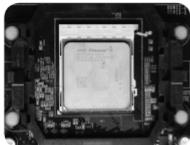
注：请勿强行安装处理器。如果处理器不能轻松安装到插座中，请检查处理器的方向和插座是否相符。强行安装将会损坏处理器或主板并失去质保。
